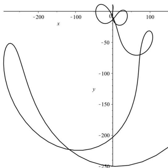
Рис. 4. Траектория свободно падающего тела в НСО  $\tau - n$ , совершающей первые 2,5 оборота по окружности радиуса  $R = 10$  с частотой  $\omega(t) = \cos t$ . Начальные условия  $X(0) = 0, Y(0) = 10, X'(0) = 0, Y'(0) = 0$ .
