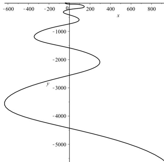
Рис. 5. Траектория свободно падающего тела в системе  $\tau - n$ , совершающей первые 4,5 оборота по окружности радиуса  $R = 10$  с угловой частотой  $\omega(t) = Bessel(1, x)$ . Начальные условия  $X(0.001) = 0, Y(0.001) = 10, X'(0.001) = 0, Y'(0.001) = 0$ .
