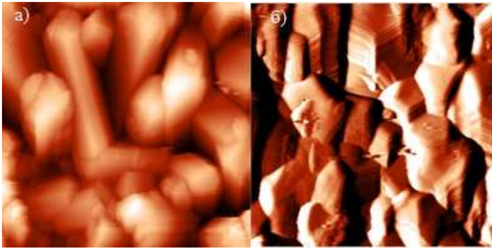
Рис. 3. Топография поверхностей перпендикулярной (а) и параллельной (б) направлению прессования для образцов пятикомпонентного состава. Размер изображения 10X10 мкм.
