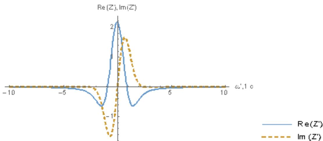
Рис. 2. График действительной и мнимой частей функции  $Z'$  при постоянной мнимой части  $\omega'' = -1,97 \times 10^8 \text{ c}^{-1}$ ,  $v_t = 6.74 \times 10^6 \frac{\text{cm}}{\text{c}}$ ,  $k\lambda_D = 0.3$
