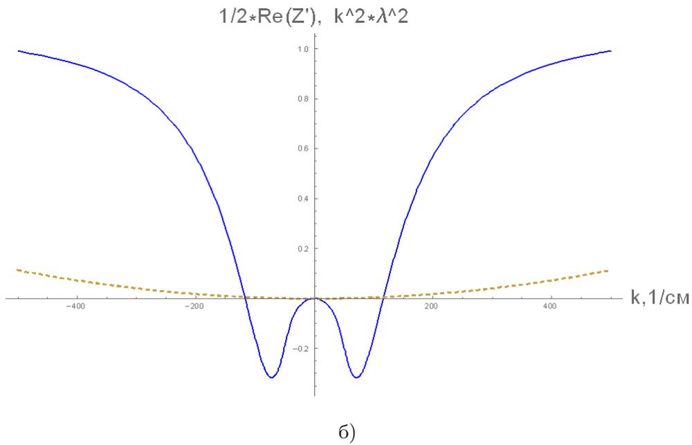
Рис. 3. Графики действительной части функций  $\frac{1}{2}Z'$  и  $k^2\lambda_n^2$  при  $\omega'' = -1,97 \times 10^8 \text{ c}^{-1}$ ,  $v_t = 6.74 \times 10^6 \frac{\text{cm}}{\text{c}}$ , в зависимости от  $k$ , а) при  $\omega' = 10^8 \text{ c}^{-1}$ , б) при  $\omega' = 10^{10} \text{ c}^{-1}$ .
