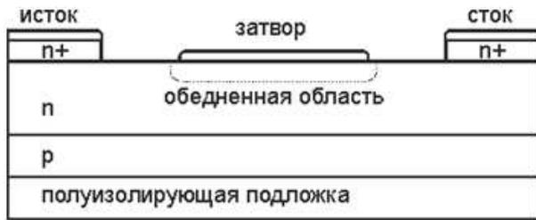
Рис. 1. Схематическое изображение конструкции ПТШ транзистора.
