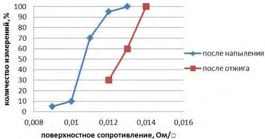
Рис. 1. Интегральное распределение поверхностного сопротивления медной металлизации на кристалле.
