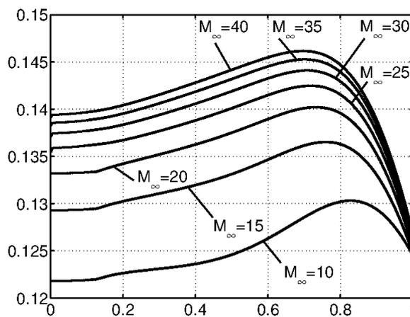
Рис. 6. Зависимость безразмерного локального теплового потока от координаты для  $M_\infty \in \{10; 15; \dots; 40\}$  при  $\sigma B_0^2 = 3 \cdot 10^3$  [Тл/Ом·м].
