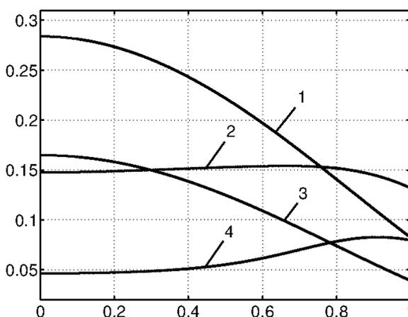
Рис. 4. Зависимость безразмерного локального теплового потока от координаты с учётом (кривые 1 и 2) и без учёта (кривые 3 и 4) эффекта диссоциации.
