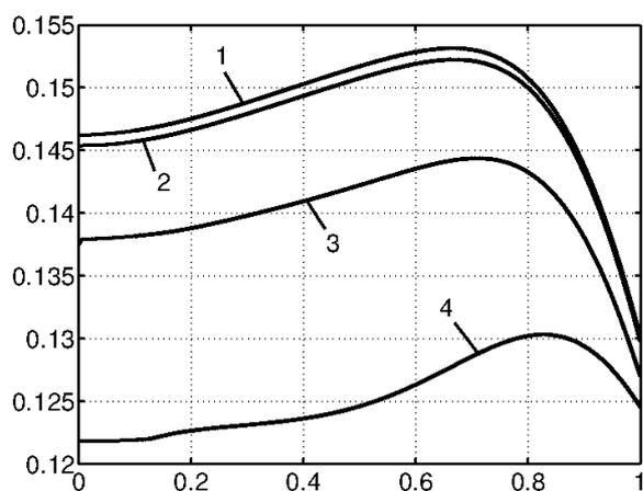
Рис. 5. Зависимость безразмерного локального теплового потока от координаты для  $\sigma B_0^2 \in \{0; 10^2; 10^3; 3 \cdot 10^3\}$  [Тл/Ом·м] при  $M_\infty = 10$ .
