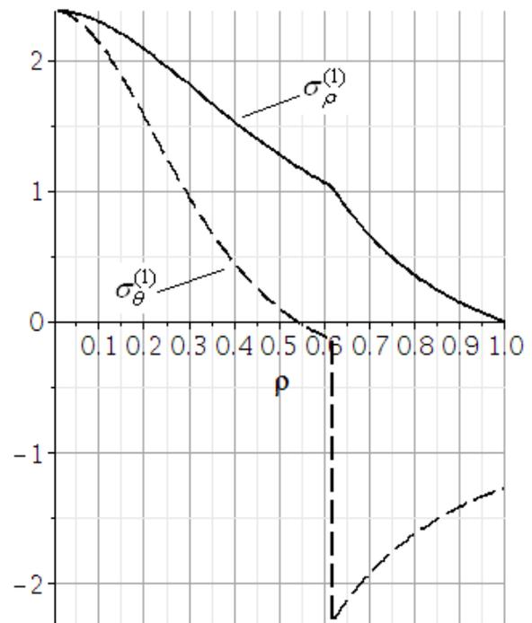
Рис. 4. Распределение напряжений первого порядка
