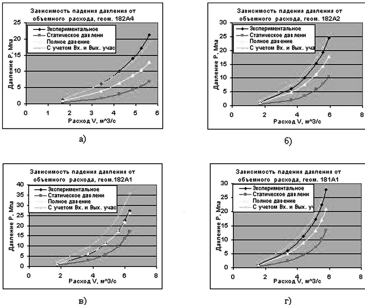
Рис. 4. Зависимости перепада давления от величины объемного расхода жидкости. Зазор между цилиндром и конусом на входе равен: а — 0.215 мм; б — 0.205 мм; в — 0.192 мм; г — 0.198 мм
