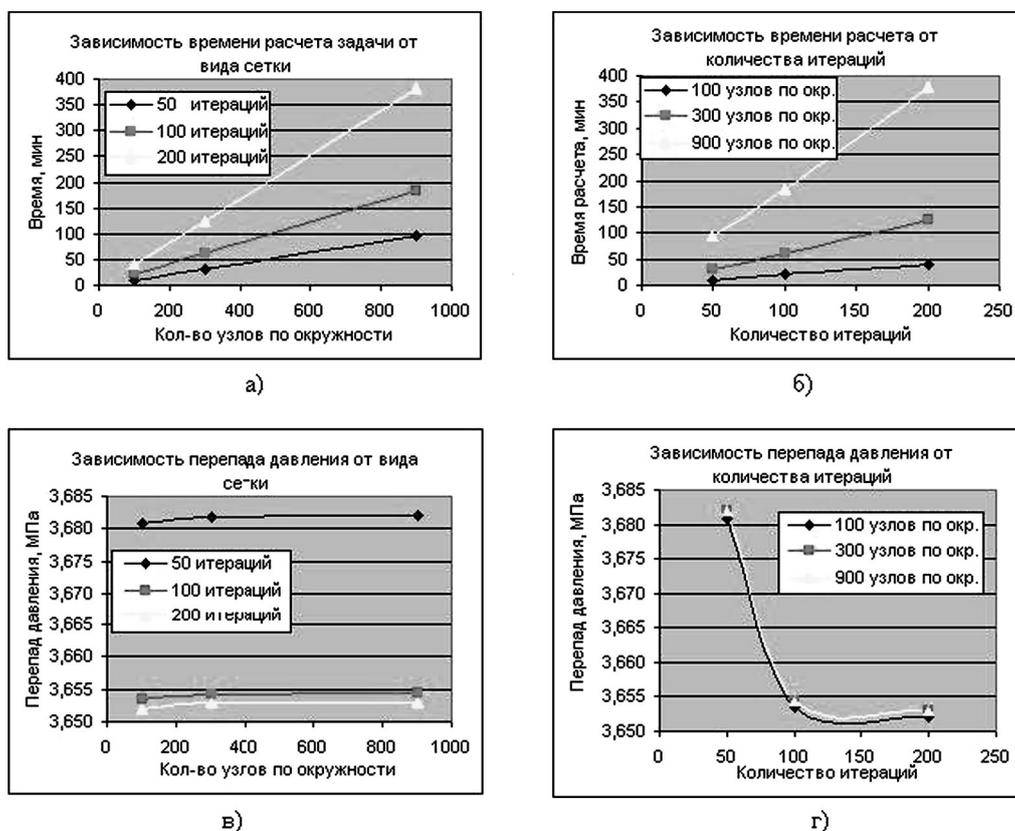
Рис. 3. Зависимость времени решения задачи и величины перепада давления от типа сеточной области и количества итераций: а, б — зависимость времени расчета от числа узлов сетки на окружности ортогонального сечения и количества итераций; в, г — зависимость перепада давления от числа разбиений окружности ортогонального сечения и количества итераций
