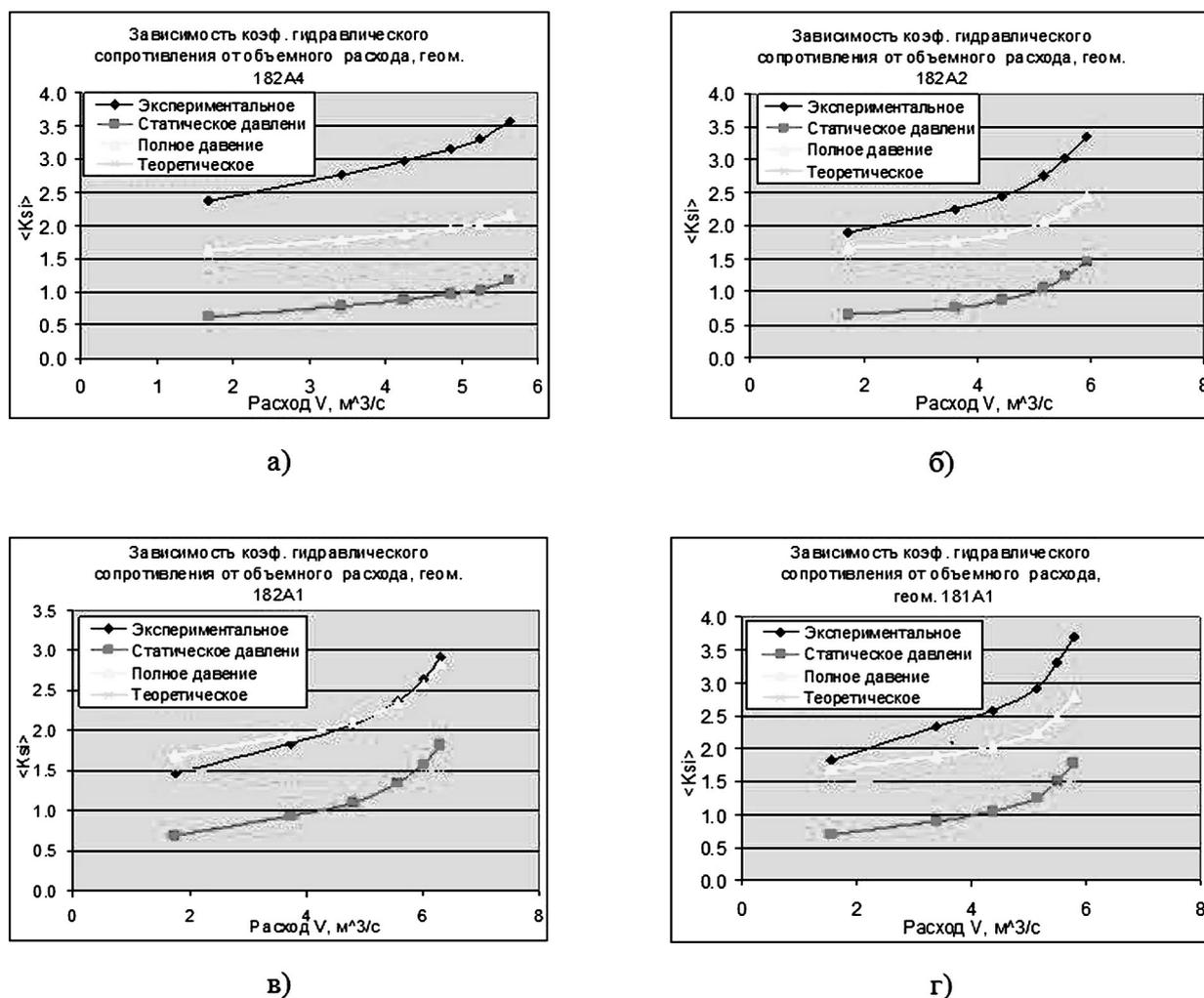
Рис. 5. Зависимость коэффициента гидравлического сопротивления от объемного расхода жидкости. Зазор между цилиндром и конусом на входе равен: а — 0.215 мм; б — 0.205 мм; в — 0.192 мм; г — 0.198 мм
