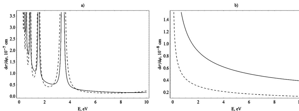
Рис. 3. Зависимость сечения рассеяния от энергии налетающего электрона (угол рассеяния в обоих случаях  $\phi = \pi/3$ ): (а) комбинация кулоновского потенциала и эффекта Ааронова—Бома (сплошная линия соответствует случаю  $\Phi/\Phi_0 = 0.1$ , пунктирная —  $\Phi/\Phi_0 = 0.8$ ); (б) “чистый” эффект Ааронова—Бома (сплошная линия соответствует случаю  $\Phi/\Phi_0 = 0.5$ , пунктирная —  $\Phi/\Phi_0 = 0.8$ )
