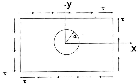
Рис. 1. Пластина под действием сдвиговых усилий
