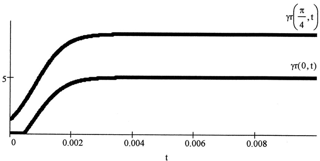
Рис. 3. Распространение упругопластической границы вдоль радиального направления  $\frac{\pi}{6}$
