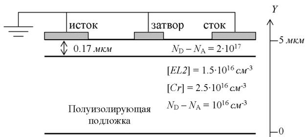
Рис. 1. Структура ПТШ, используемая для численного моделирования
