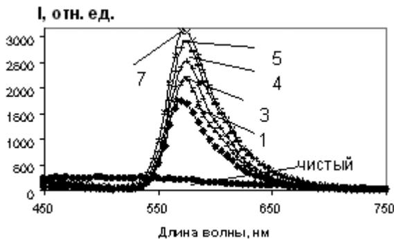
Рис. 4. Спектры люминесценции ионитов КУ-23 с адсорбированными молекулами Р6Ж при различной длительности процесса адсорбции.  $\lambda_{\max} = 575$  нм (цифрами обозначены часы после начала процесса адсорбции)
