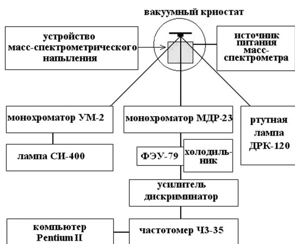
Рис. 3. Блок-схема автоматического спектрального комплекса для исследования механизма люминесценции ионно-ковалентных кристаллов
