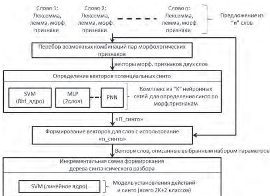
Рисунок. Схема алгоритма формирования дерева синтаксического разбора в соответствии с выбранными признаками и нейросетевыми моделями: К – количество синто в текстах НК
