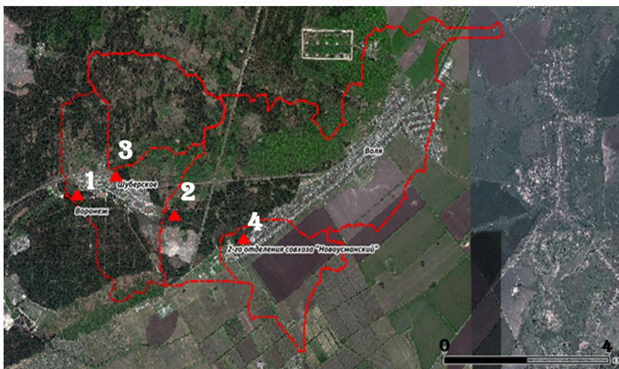
Рис. 2. Границы водосборов в с. п. Шуберское. Условные обозначения: - • - - границы (водоразделы) водосборов, ▲ 1, 2, 3, 4 - замыкающие створы и номера водосборов.
