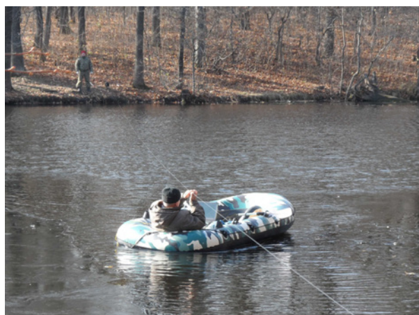
Рис. 2. Георадиолокационное обследование пруда с антенной 500 МГц.
