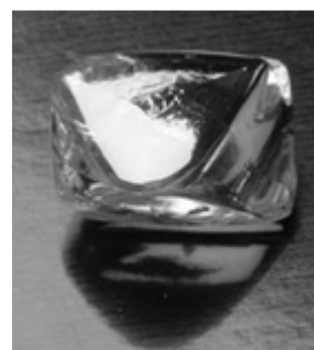
Рис. 5. Один из крупных ювелирных алмазов – бесцветный октаэдр массой 16,48 карат. Найден в 2005 г. на месторождении Семпака (Semangka), юго-восток Калимантана. По Ian Graham et al. [17, рис. 2].
