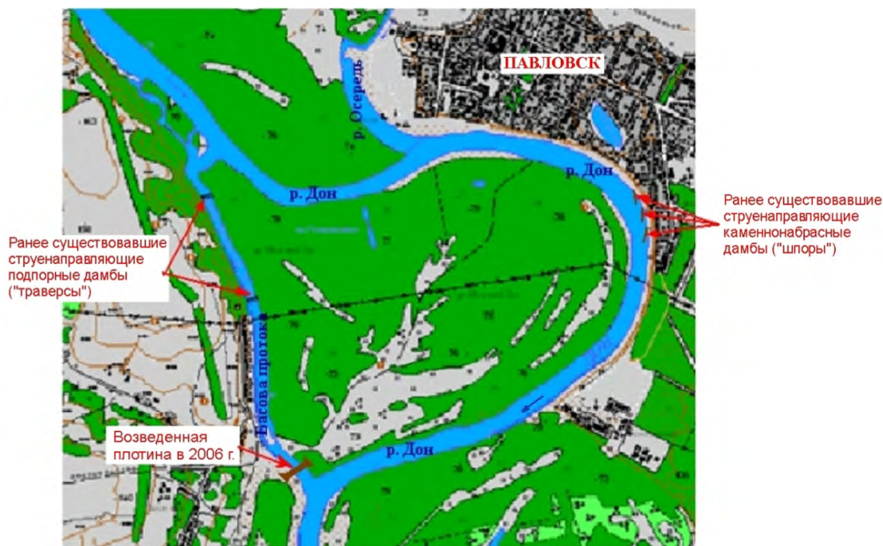
Рис. 2. Схема, поясняющая причину активной береговой эрозии на р. Дон в г. Павловске.
