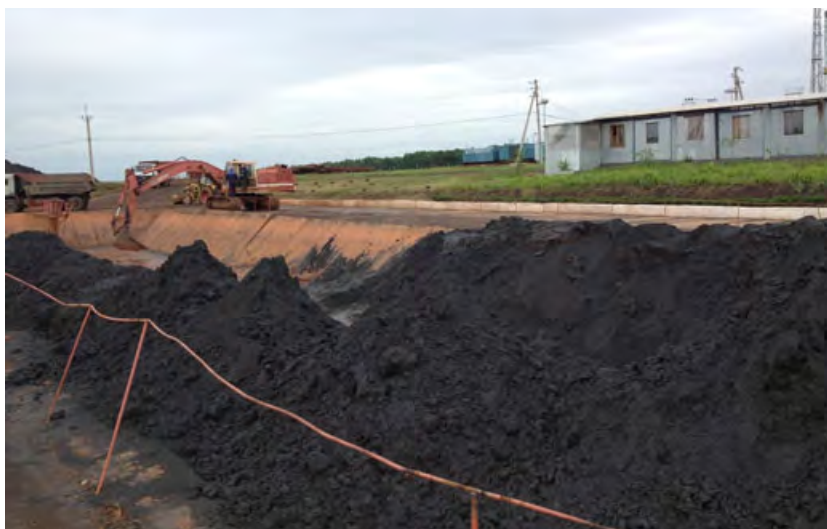
Рис. 1б. Рудоприёмник Болшетроицкого рудника, начало отгрузки богатой железной руды – технологической пробы с Fe_{\text{общ.}} = 72,1 \% . Фото И. И. Никулина.
