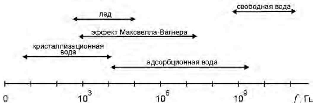
Рис. 2. Положения областей дисперсии диэлектрической проницаемости различных форм влаги на шкале частот (по G.P. De Loor, с изменениями).
