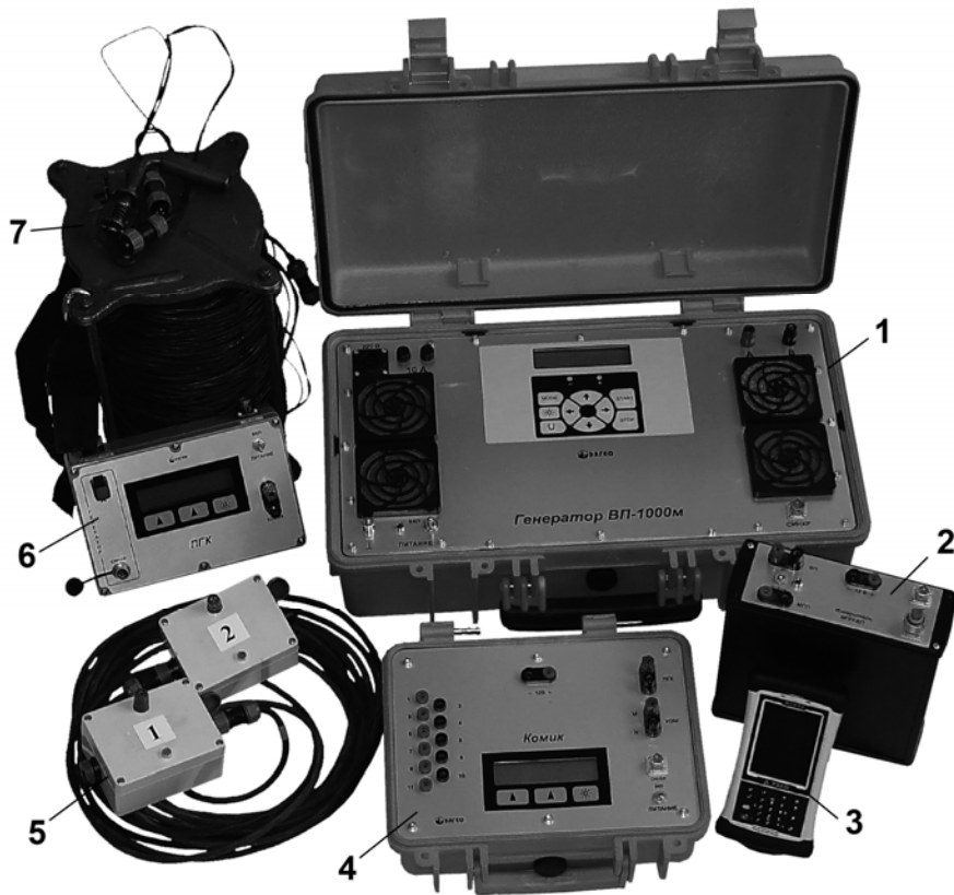
Рис. 1. Аппаратура системы электротомографии АСЭТ-ВП: 1 – генератор ВП-1000М, 2 – измеритель МПП-ВП, 3 – управляющий КПК, 4 – коммутатор измерительной косы КОМИК, 5 – модули-переключатели генераторной косы, 6 – пульт генераторной косы ПГК, 7 – трёхжильный кабель генераторной косы на катушке.
