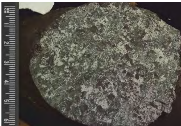
Рис. 7. Эпигенетические изменения (бертьеринизация) остаточной коры выветривания на Хохловском участке, скв. 1гт, гл. 546,0 м: бертьерин – зеленоватая и сероватая масса; гидрогематит – буровато-фиолетовая.
