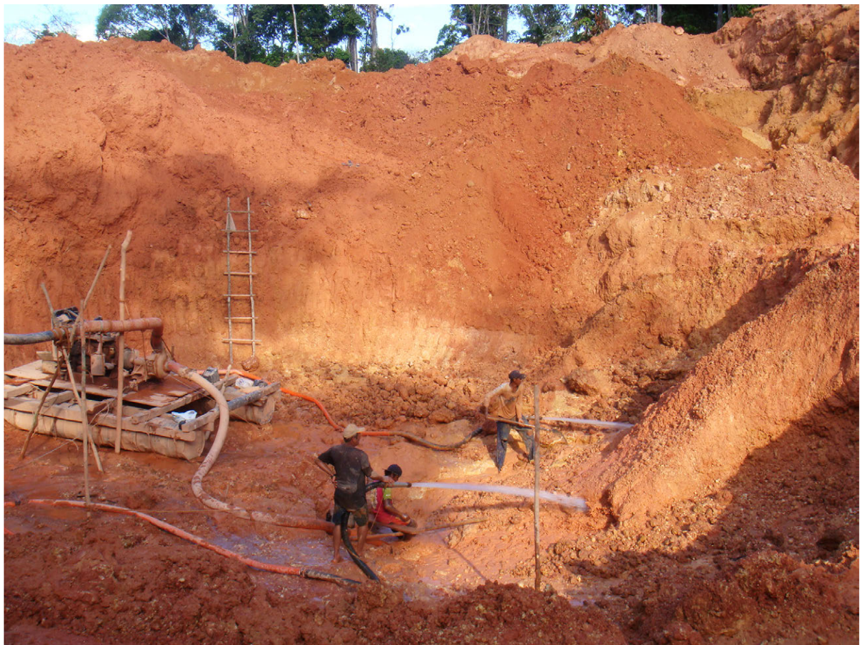
Рис. 1. Отработка россыпи гидромониторами после разрыхления продуктивного пласта экскаватором
