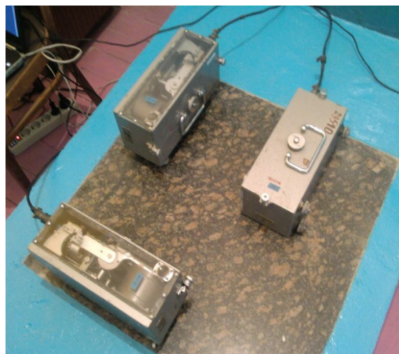
Рис. 3. Модифицированные классические сейсмометры ВЕГИК повышенной чувствительности, расположенные на постаменте станции "Кривой Рог"
