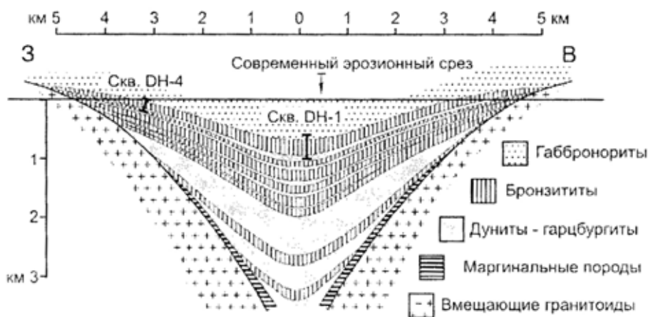
Рис. 3. Обобщенный поперечный геологический разрез Великой Дайки в южной части субкамеры Дарвендэл (по [5]).
