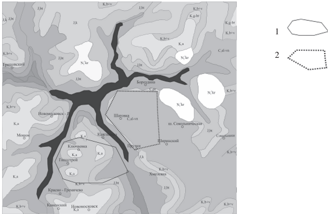
Рис. 1. Геологическая карта района: 1 – контуры Новомосковского месторождения гипса, 2 – контуры северо-восточного участка Новомосковского месторождения гипса
