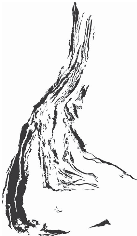
Рис. 7. Костомукшское месторождение железистых кварцитов. План расположения тел железистых кварцитов на горизонте +170 м.
