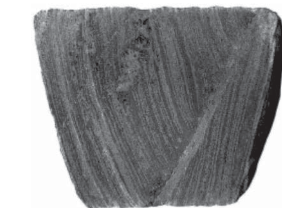
Рис. 3. Фрагмент внутрирудной блокировки железистых кварцитов Кировогорского месторождения с шарнирным вращением микроблоков.
