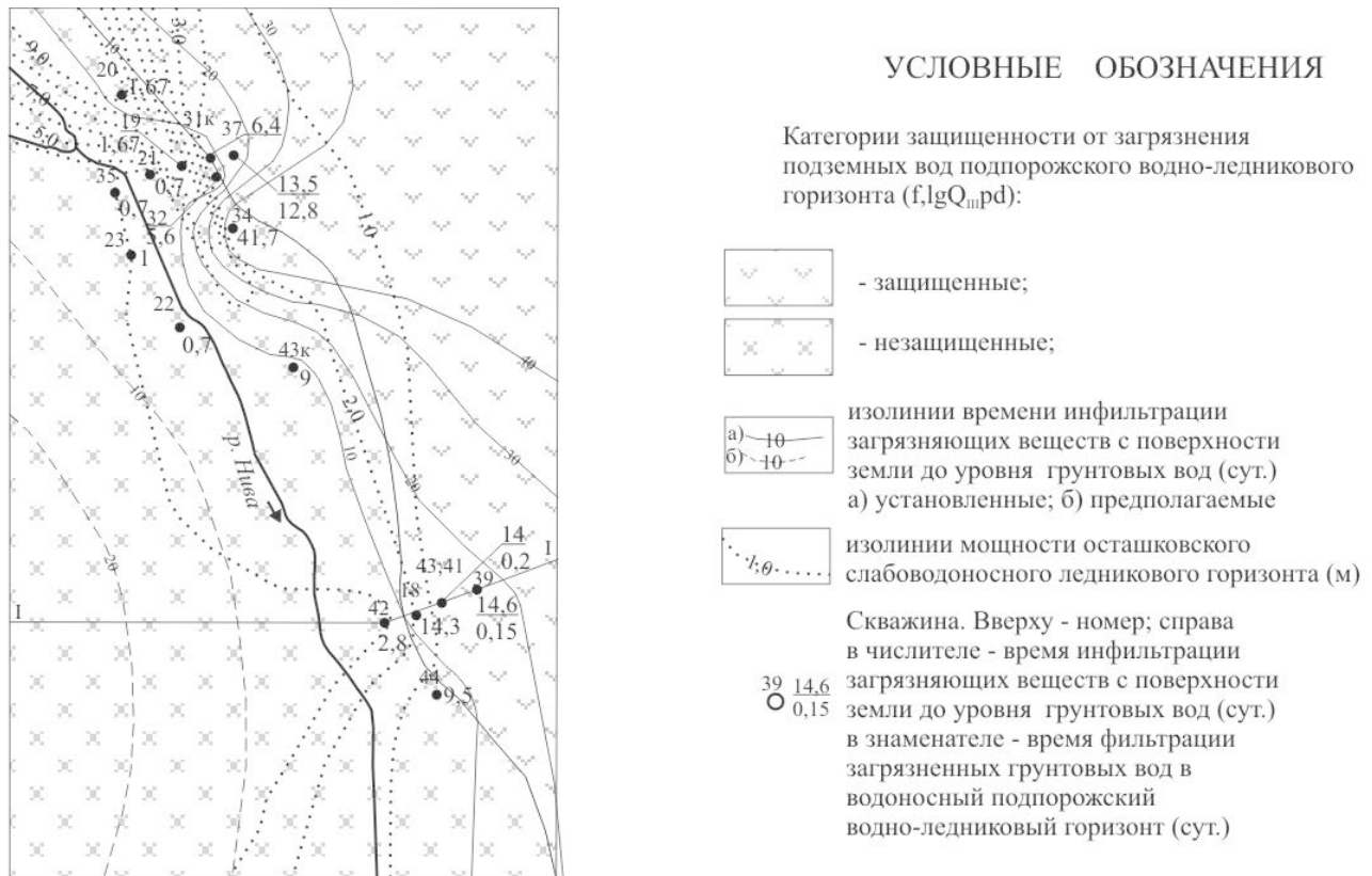
Рис. 2. Схематическая карта условий защищенности от загрязнения подземных вод в долине р. Нивы (масштаб 1 : 10 000)
