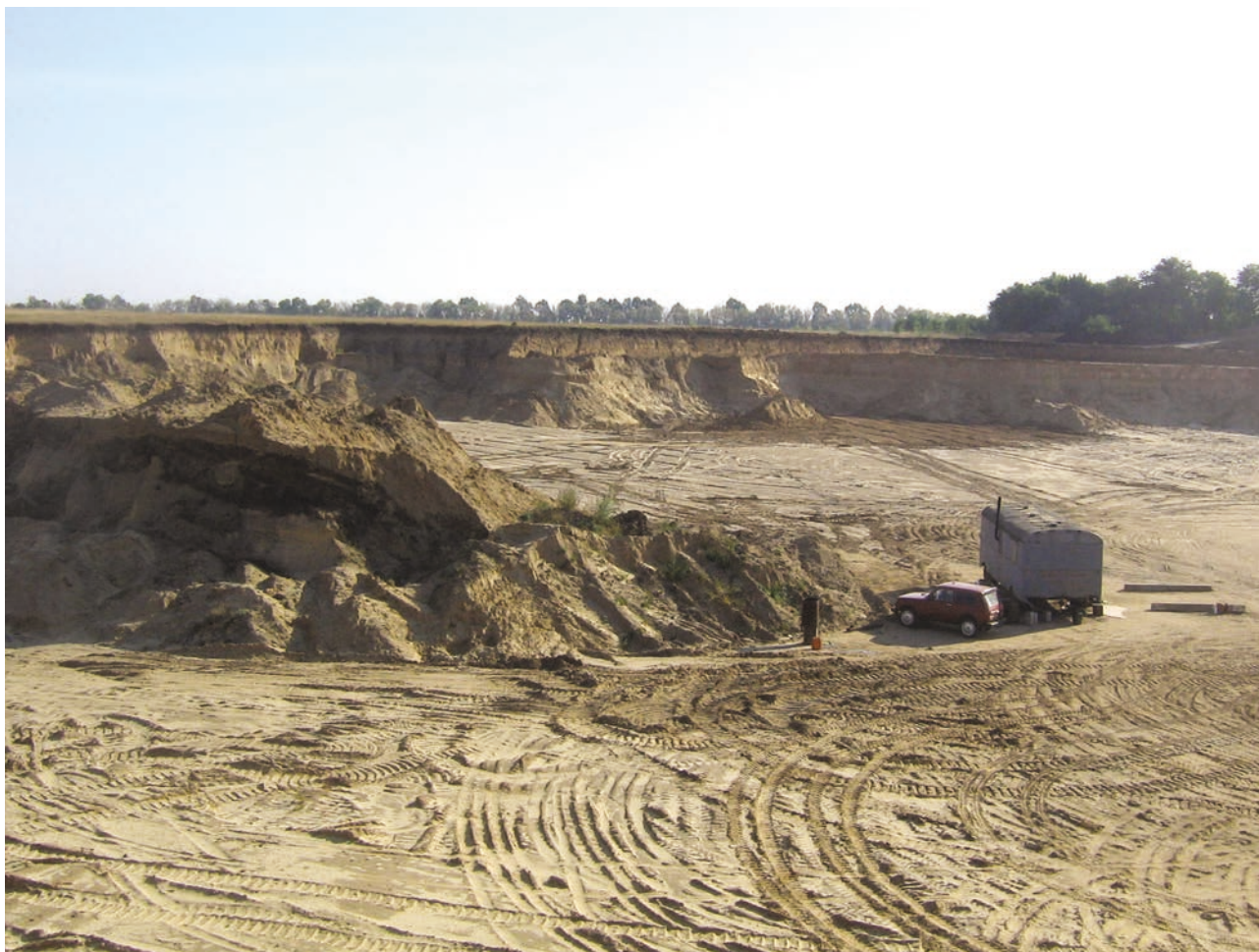
Рис. 2. Аллювиальная толща 4-й надпойменной террасы, вскрытая в северо-западной стенке карьера на месторождении «Ударное»
