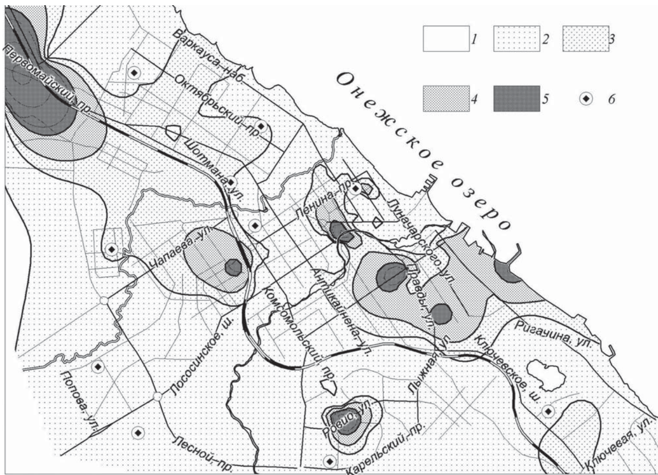
Рис. 2. Схема загрязнения почв свинцом. Уровни загрязнения: 1 – минимальный ( K_{\text{одк}} < 1 ), 2 – низкий ( 1 < K_{\text{одк}} < 1,5 ), 3 – средний ( 1,5 < K_{\text{одк}} < 2 ), 4 – высокий ( 2 < K_{\text{одк}} < 3 ), 5 – очень высокий ( 3 < K_{\text{одк}} ); 6 – точки отбора соцветий березы
