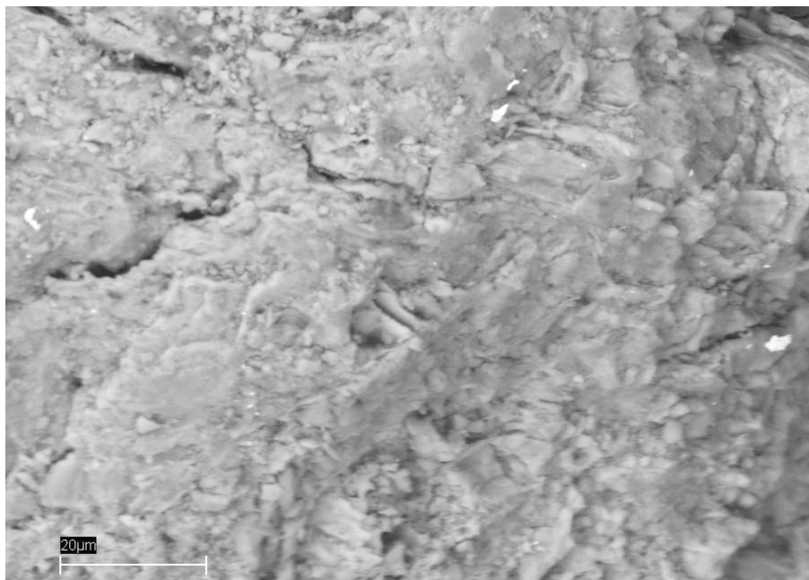
Рис. 3. Тонкодисперсная вкрапленность зерен самородного золота (от долей \mu\text{m} до 2 \mu\text{m} ) во вторичном агрегате, состоящем из гидроокислов железа (проба 220409). [Минералого-геохимические исследования Лапухова, 2010 г.]
