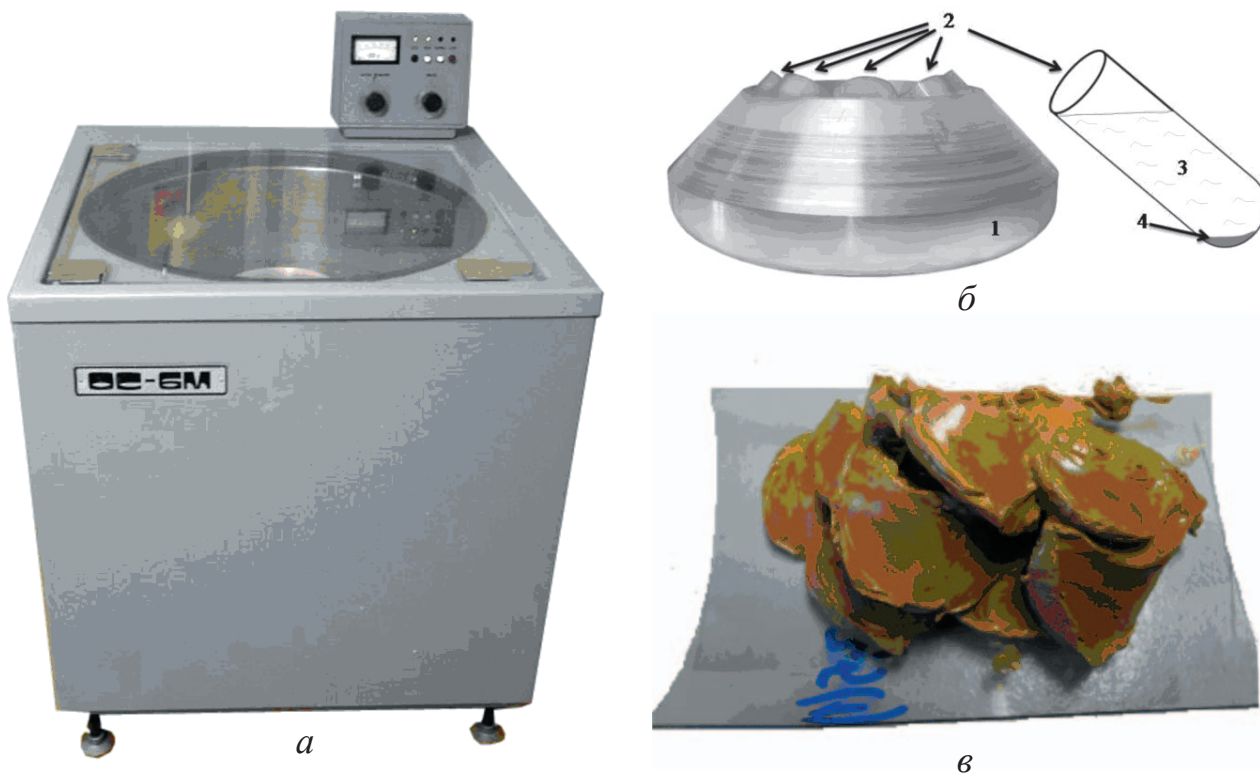
Рис. 3. Основные элементы отжима глинистой суспензии при помощи центрифуги: а – высокоскоростная центрифуга ОС-6М в сборе; б – после центрифугирования: 1 – угловой ротор; 2 – полиэтиленовая, гибкая колба; 3 – прозрачная жидкость; 4 – отжатая глина на дне колбы; в – высохшая фракция мельче 0,001 мм, пригодная для дальнейших лабораторных исследований
