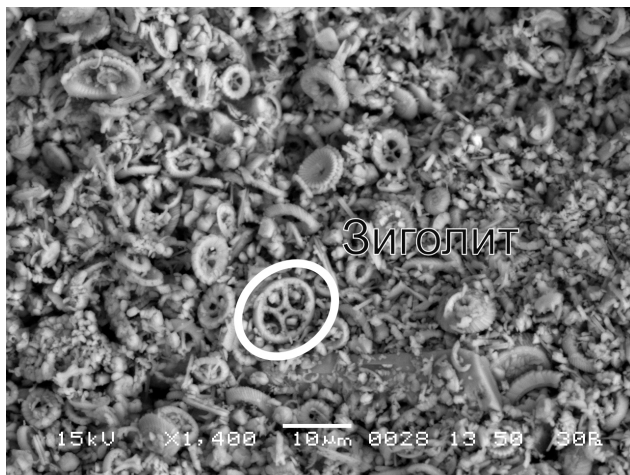
Рис. 9. Электронномикроскопический снимок естественной поверхности скола туронского песчяного мела, Курская область, увеличение 1400. Зиголит
