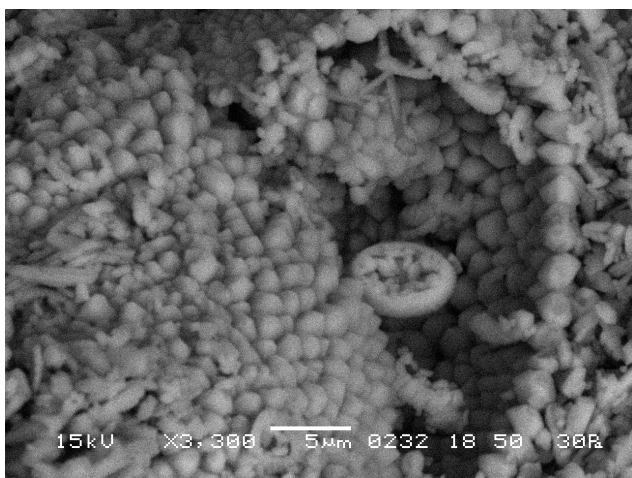
Рис. 2. Электронномикроскопический снимок естественной поверхности скола туронского песчаного мела, Белгородская область (Лебединский карьер), увеличение 3300. Фрагмент раковины фораминиферы
