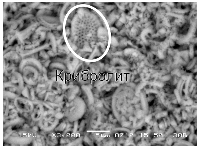
Рис. 7. Электронномикроскопический снимок естественной поверхности скола кампанского писчего мела, г. Белгород, увеличение 3000. Крибrolит
