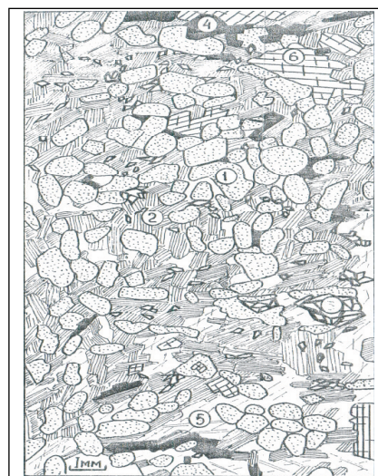
Рис. 2. Апатит-силикатная руда (скв. 5402, глуб. 228,2 м). Мелкозернистый апатит (1) находится в мелкочешуйчатом биотитовом (2) агрегате, насыщенном мельчайшими кристалликами и скоплениями сфена (3). В биотит-апатитовом агрегате рассеяны зерна магнетита (4), ксеноморфные сульфиды, выделения кальцита (5) и редкие корродированные кристаллы щелочного пироксена (6)
