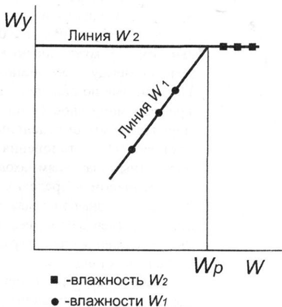
Рис.3. Расчетная схема для вывода формулы границы раскатывания
