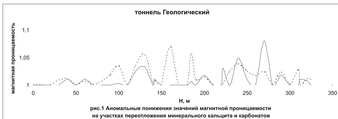
Рис. 1. Аномальные понижения значений магнитной проницаемости \mu на участке переотложения минерального кальцита (Ca) и карбонатов (CaCO 3 )
