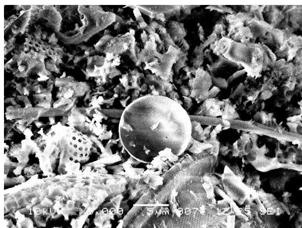
Рис. 12. Электронномикроскопический снимок диатомита: обр. 65704
