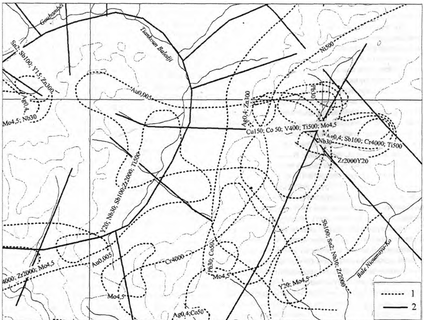
Рис. 3. Схема дешифрирования материалов АФС и полиэлементные аномалии по результатам региональных работ на участке Боене-II (сеть опробования 500×250 м):
