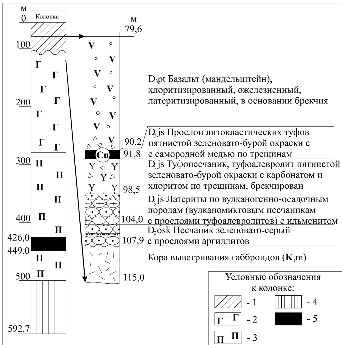
Рис. 4. Колонка скважины № 227 а с интервалом находки самородной меди: 1 – породы осадочного чехла (D-Q); 2 – габбронориты, габбро завершающей фазы мамонского комплекса дунит-перидотит-пироксенит-габброноритового комплекса (K 1m ) с ксенолитами гнейсов; 3 – перидотиты, оливиновые пироксениты ранней фазы мамонского комплекса (K 1m ), на отдельных участках серпентинизированные; 4 – гнейсы воронцовской серии (K 1vc ); 5 – сульфидная пирротин-пентландит-халькопиритовая руда в серпентинизированных перидотитах
