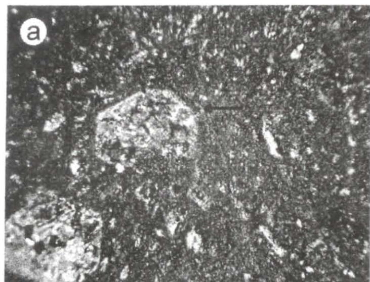
Рис. 9. Нефелинит. Идиоморфные шестиугольные таблички нефелина (указаны стрелками). Обр. 11/62. Отраженный свет. Ширина поля зрения 0,5 мм.
