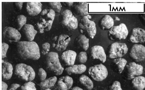
Рис.11. Метасоматический глауконит, возникший за счет глауконитизации глинистых комочков. Обращает на себя внимание полное отсутствие трещин синерезиса даже у относительно крупных зерен. Искусственный концентрат, отраженный свет.
