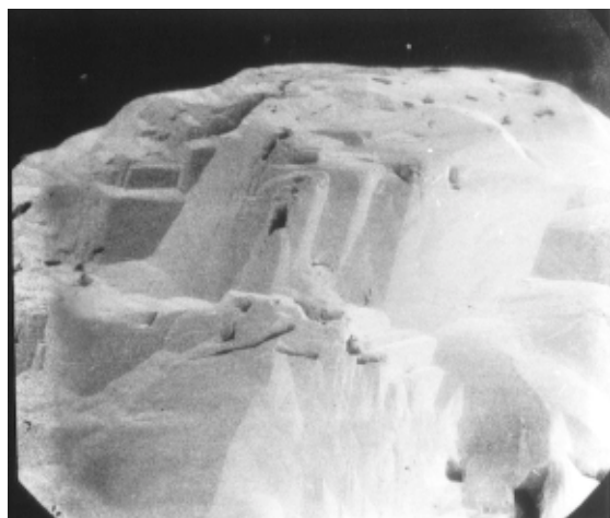
Рис.3. Крупночерепитчатый, ступенчатый рельеф поверхности алмаза V разновидности. Увел. 100х.
