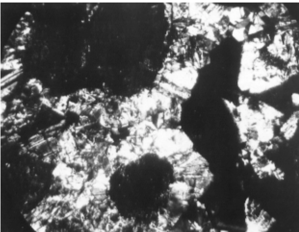
Рис.6. Оторочки крупнокристаллического гипбсита II вокруг псевдобовин бертьерин-гипбситового боксита: скв. 1230, глуб. 597,0 м. Петропавловский участок. Николи II. Увеличение 25.
