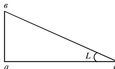
Из приведенного чертежа, где  $c$  – точка стояния инструмента,  $b$  – наблюдаемый отсчет при наклонности инструмента  $L$ ,  $a$  – истинный отсчет, легко видеть, что соответствующая поправка будет равна
