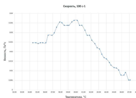
Рис. 4. Зависимость вязкости гидрогеля с рН 7,3 от температуры.
