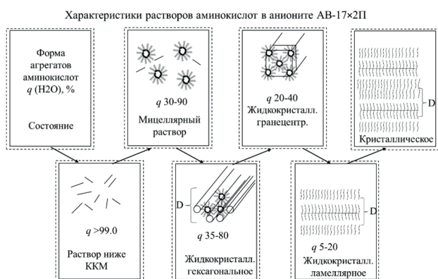
Рис. 9. Варианты фаз аминокислот в диапазоне между раствором цвиттерлита и кристаллом
