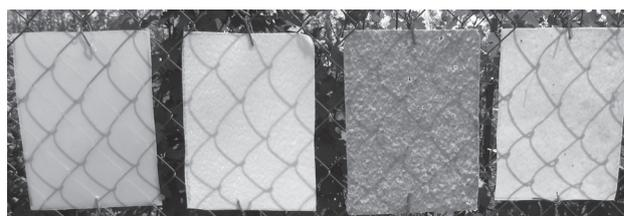
Рис. 3. Испытание образцов высоконаполненного полисахаридами полиэтилена на стойкость к естественным климатическим факторам
