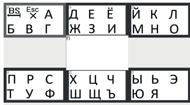
Рис. 2. Графическая форма видеоокулографического интерфейса. В верхнем левом углу выделен предварительно выбранный пользователем блок.
