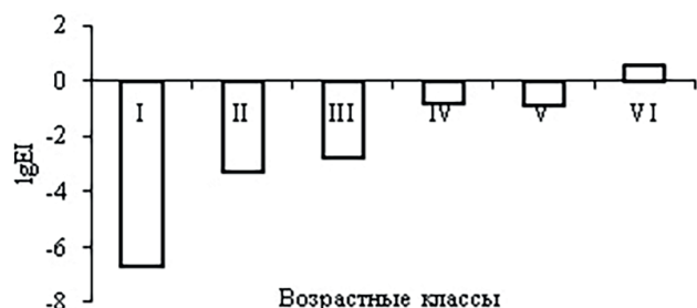
Рис. 4. Отношение жесткости на изгиб (EI) ро- биний для разных возрастных классов
