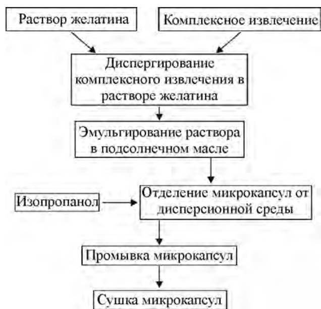
Рис. 1. Общая схема получения микрокапсул с комплексным фитоизвлечением методом диспергирования.
